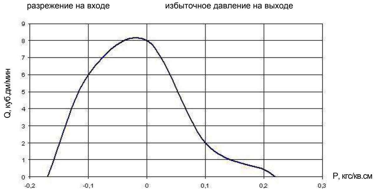
Рисунок 1.1 – Типовая зависимость производительности побудителя по воздуху от давления (разрежения) на его выходе (входе)
